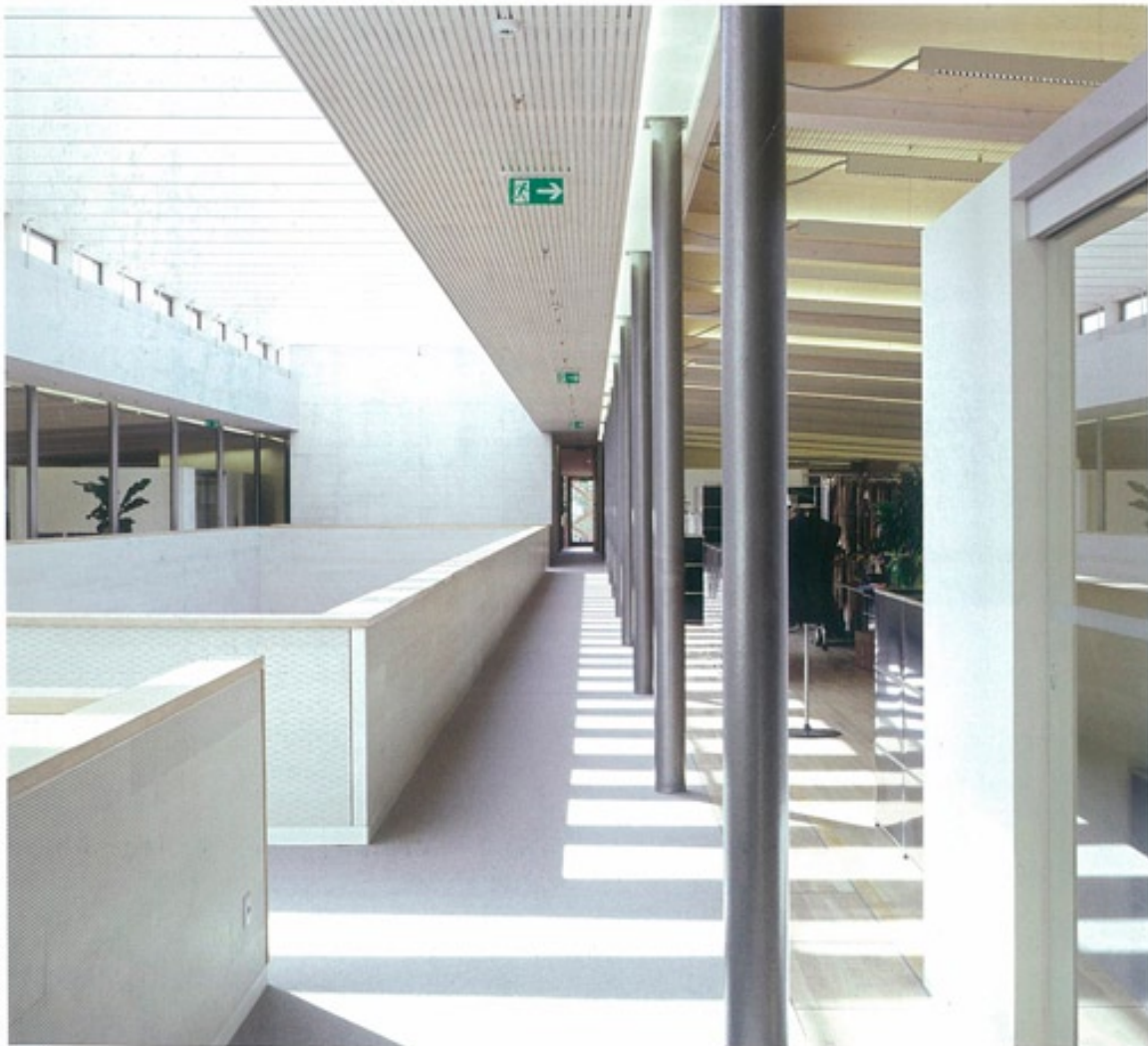
Perforierte Holzpaneele sind kleidsam und dienen als schallschlückende Elemente. Perforated wood panels are attractive and serve as sound-absorbing elements.
