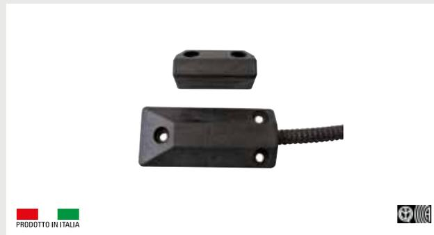
Contatto magnetico di dimensioni ridotte in materiale plastico ultraresistente caricato vetro per porte basculanti; omologato IMQ con la norma europea EN50131-2-6 grado 2 classe ambientale IV. Contatto N.C. con anta chiusa. Il contatto si adatta all'installazione al suolo grazie ad un profilo di soli 13mm. Contatto chiuso con magnete ad una distanza non superiore a 25mm.
