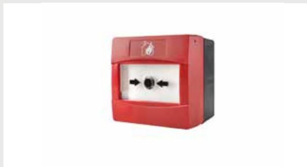
Pulsante di allarme da esterno IP67 ripristinabile a chiave per impianti di rilevazione incendio. Corpo in materiale plastico di colore rosso. Certificazione EN54-11.
