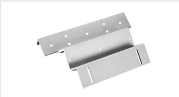
Set di staffe a Z e L in alluminio, per porte con apertura verso l'interno per modelli da 180Kg. Dimensioni staffa a L 185x41,8x25,4(mm), staffa a Z 130x38x38(mm).
