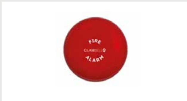
Campana antincendio diametro 150 mm in versione per interni. Gong in alluminio per elevata resa acustica e maneggevolezza. Alimentazione 24Vcc 12mA. Certificazione CPR EN54-3. Fornita con fondo plastico per il montaggio a muro.
