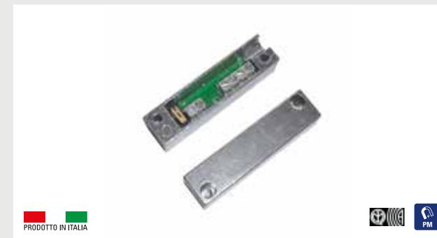
Contatto magnetico di sicurezza in alluminio pressofuso da superficie per infissi in materiali ferromagnetici e non. Omologato IMQ con la norma europea EN50131-2-6 grado 3 classe ambientale II. Bilanciamento magnetico integrato per la protezione contro le manomissioni. Contatto N.C. con anta chiusa, connessione a morsetti. Tamper anti-rimozione su parte reed.
