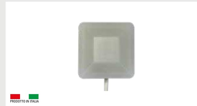
Ripetitore ottico da esterno IP65 con tecnologia LED RGB che permette la scelta del colore desiderato combinando i tre ingressi con negativo a dare. Contenitore in policarbonato opale a diffusione uniforme. Regolatore di corrente integrato che permette di alimentare il dispositivo da 10,5Vcc a 27,6Vcc senza variazioni di luminosità. Versioni lampeggianti o a luce fissa.
