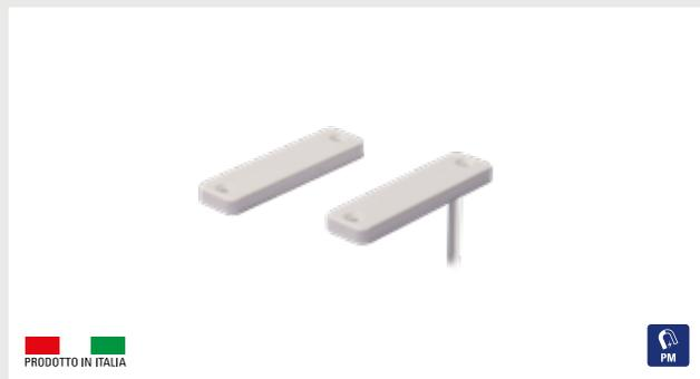
Contatto magnetico di sicurezza in ABS da superficie per infissi in materiali non ferromagnetici. Conformità con la norma europea EN50131-2-6 grado 3 classe ambientale II. Bilanciamento magnetico integrato per la protezione contro le manomissioni. Contatto N.C. con anta chiusa, cavo di collegamento 4 poli 1m. Funzionamento esclusivamente frontale con uscita cavo dalla parte inferiore.
