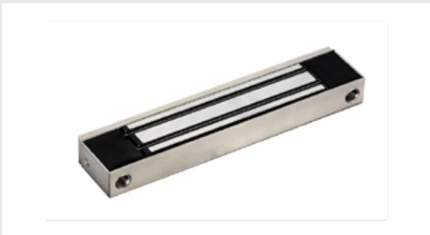
Chiusura elettromagnetica impermeabile 280kg IP68 con stato porta. Ideale per installazione in superficie su porte in legno, metallo, vetro, porte scorevoli e porte tagliafuoco. Dimensioni 225Lx48Px35H(mm) Contropiastra 180Lx38.8x13.2H(mm). Tensione di alimentazione DC 12V o DC 24V. Temperatura di funzionamento -30~+66°C
