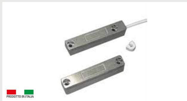
Sensore magnetico per superficie in alluminio pressofuso protetto dalle sovratensioni, adatto al pilotaggio di carichi induttivi come relè o motori con i limiti dettagliati nelle caratteristiche elettriche. Adatto a infissi in materiale ferromagnetico e non. Versione totalmente resinata per esterno o interno. Viti e tappi copri vite a pressione compresi.
