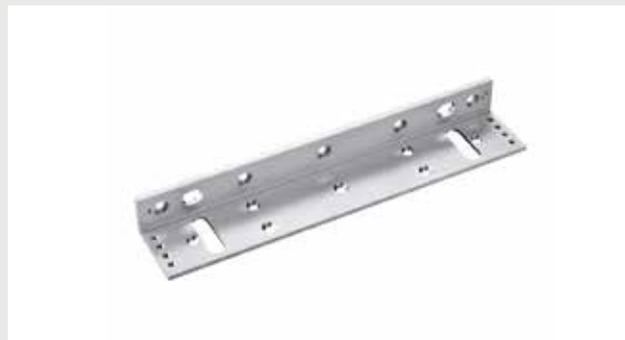
Staffa a L in alluminio ad alta resistenza, finitura sabbata, per fissaggio a vista degli elettromagneti su infissi di sezione ridotta per modelli da 280Kg. Dimensioni 250x48,8x30,4(mm).
