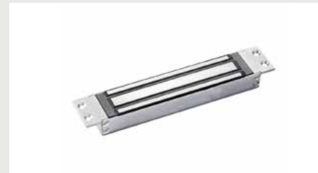
Chiusura elettromagnetica da incasso da 280kg, in acciaio inossidabile IP65, con segnalazione stato porta con contatto reed. Ideale per installazione su porte in legno, metallo e porte tagliafuoco. Dimensioni 231,5Lx41Px25,5H (mm) - Contropiastra 180Lx38,8Px13.2H (mm). Tensione di alimentazione DC 12V o DC 24V. Temperatura di funzionamento -20°C/+55°C.
