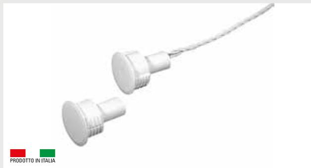
Sensore magnetico in ABS per porte blindate. Contatto reed ausiliario indipendente per gestione di sistemi diversi come controllo accessi o climatizzazione. Ghiera di fissaggio alettata e molleggiata. Installazione con foro diametro 20 mm che preserva la capacità magnetica del sensore e permette di mantenere distanze di funzionamento fino a 20 mm.
