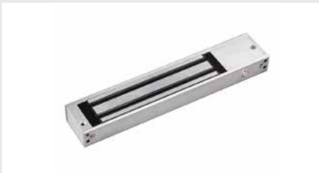
Chiusura elettromagnetica per superficie da 280Kg in alluminio anodizzato. Ideale per installazione su porte in legno, metallo, vetro e porte tagliafuoco. Dimensioni 250Lx48,8px27,9H(mm) - Contropiastra 180Lx38,8px13,2H(mm). Tensione di alimentazione DC 12V o DC 24V. Temperatura di funzionamento -20°C/+55°C.
