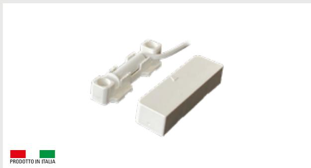
Sensore inerziale elettromeccanico passivo da esterno per installazione in superficie su serramenti in posizione verticale con connessione a cavo. Elemento interno adatto anche per installazioni ad incasso. Viti di fissaggio a scomparsa. Predisposizione per il passaggio cavi sia sui lati che sul fondo. Necessita scheda di analisi per contatti veloci.
