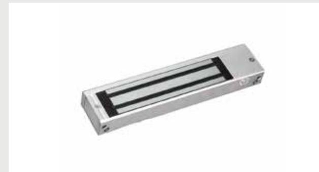
Chiusura elettromagnetica per superficie da 180Kg, in alluminio anodizzato, con stato porta con contatto reed. Ideale per installazione su porte in legno, metallo, vetro, porte scorrevoli e porte tagliafuoco. Dimensioni 185Lx41,8Px22,4H(mm) - Contropiastra 130Lx32x10H(mm) Tensione di alimentazione DC 12V o DC 24V. Temperatura di funzionamento -10°C/+55°C.
