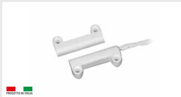
Contatto magnetico per superficie di media portata conforme con la normativa europea EN50131-2-6 grado 2 classe ambientale IV. Contatto N.C. con anta chiusa. Contenitore plastico a vista per l'installazione su porte e serramenti non ferromagnetici. Collegamento con 4 fili di lunghezza 30 cm. Disponibile anche con contatto di scambio NA/NC
