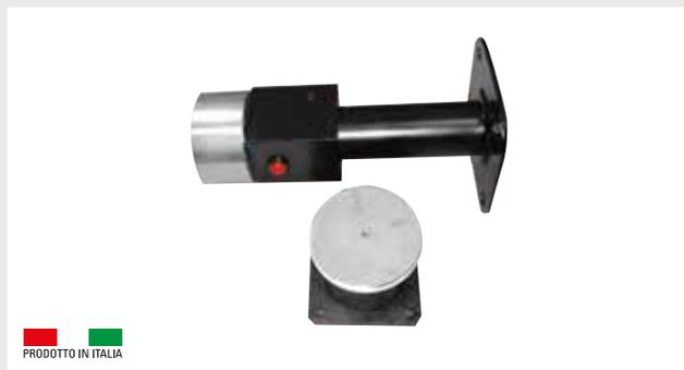
Fermo elettromagnetico per porte taglia fuoco con supporto distanziale per fissaggio a muro o a pavimento. Certificazione EN1155. Forza di ritenuta 50Kg. Pulsante di sblocco. Alimentazione 24Vcc 60mA.
