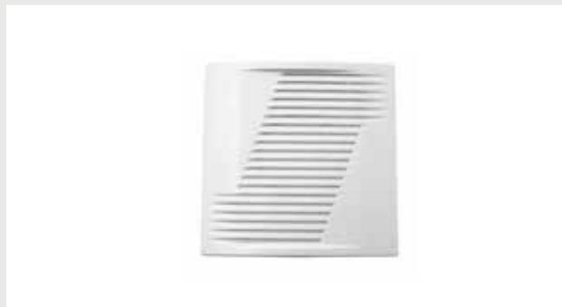
Sirena piezoelettrica da interno a basso profilo per impianti antintrusione. Livello sonoro di uscita 115dB. Tono di uscita programmabile: continuo o alternato. Conforme EN50131 grado 3 classe ambientale II. Tamper di protezione antiapertura e antirimozione.
