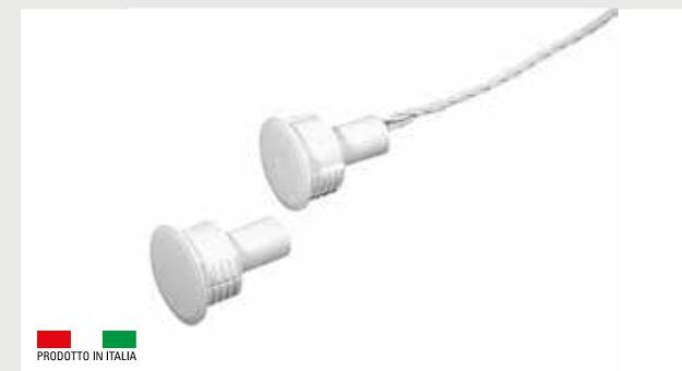
Sensore da incasso per porte blindate protetto dalle sovratensioni, adatto al pilotaggio di carichi induttivi come relè o motori con i limiti dettagliati nelle caratteristiche elettriche. Ghiera di fissaggio alettata e molleggiata consente l'installazione praticando un foro diametro 20 mm che preserva la capacità magnetica del sensore.
