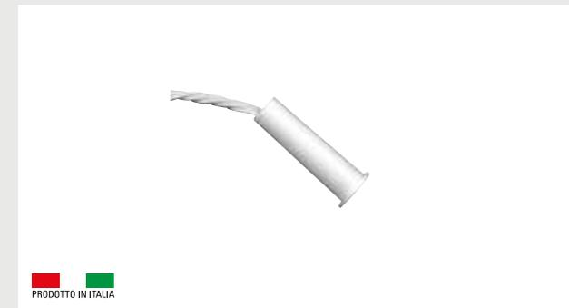
Sensore inerziale da incasso in materiale plastico per la protezione di infissi di qualsiasi materiale; diametro foro di fissaggio 9mm. Collegamento a 4 conduttori lunghezza 30cm. Necessita di circuito di analisi per sensori veloci.
