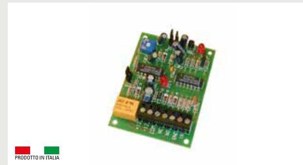
CIRCUITO DI ANALISI PER SENSORI A FILO O ROTELLA PER TAPPARELLE. MAX 5 SENSORI A FILO PER OGNI CIRCUITO. RILEVA LA LINEA APERTA E DISPONE DI UN RELÈ DI ALLARME A CONTATTO DI SCAMBIO. IMPOSTAZIONE DEGLI IMPULSI TRAMITE PONTICELLI E TRIMMER DI REGOLAZIONE. IL RELÈ DI ALLARME È PROGRAMMABILE PER IL FUNZIONAMENTO NORMALMENTE ATTRATTO O NORMALMENTE RILASCIATO.
