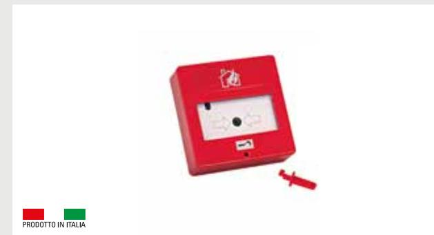
Pulsante di allarme ripristinabile a chiave per impianti di rilevazione incendio. Corpo in materiale plastico di colore rosso. Certificato EN54-11. 1 Contatto di allarme in scambio e LED di memoria allarme. Morsetti di collegamento.
