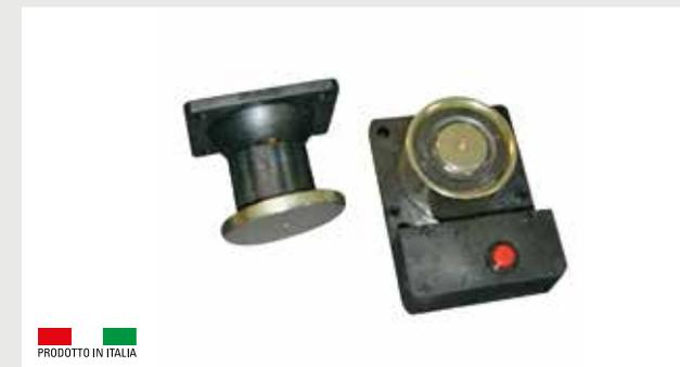
Fermo elettromagnetico per porte tagliafuoco. Certificazione EN1155. Forza di ritenuta 50Kg. Supporto in plastica rinforzata vetro e snodo a regolazione rapida. Pulsante di sblocco. Alimentazione 24Vcc 60mA. Modalità a basso assorbimento selezionabile.
