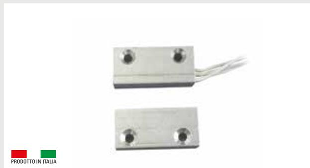
Contatto magnetico di dimensioni ridotte per superficie di media portata conforme con la normativa europea EN50131-2-6 grado 2 classe ambientale IV. Contatto N.C. con anta chiusa. Contenitore in alluminio a vista per l'installazione su porte e serramenti non ferromagnetici. Collegamento con 4 fili di lunghezza 30 cm. Disponibile anche con contatto di scambio NA/NC e contenitore anodizzato in colore marrone, verde e nero.
