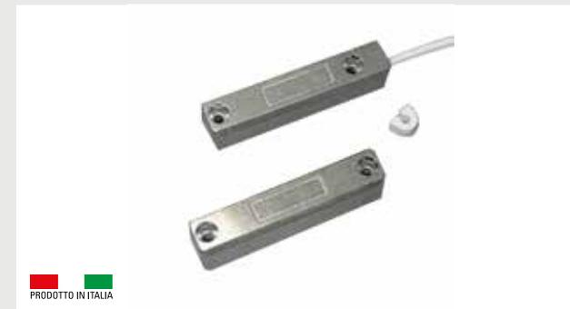
Sensore magnetico per superficie in alluminio pressofuso con 2 contatti NC indipendenti. Adatto a infissi in materiale ferromagnetico e non. Contatto ausiliario indipendente integrato per domotica, controllo accessi o climatizzazione. Versione con cavo 6 poli totalmente resinata per esterno o interno. Viti e tappi copri vite a pressione compresi.
