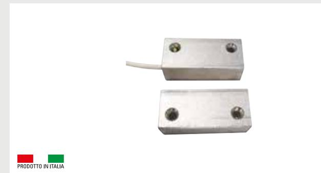
Contatto magnetico per superficie di grande portata conforme con la normativa europea EN50131-2-6 grado 2 classe ambientale IV. Contatto N.C. con anta chiusa. Contenitore in alluminio di elevata resistenza agli urti, per l'installazione su porte e serramenti in materiali ferromagnetici e non. Collegamento con cavo a 4 fili di lunghezza 1m.
