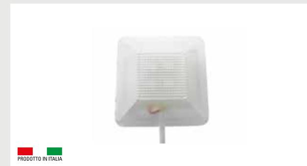
Ripetitore ottico con led di grande potenza per installazione in esterni. Grado di protezione IP65. Ottima visibilità anche in condizioni di luce diurna. Alimentazione 12/24Vcc con basso assorbimento. Disponibile in 5 colori: Rosso, Giallo, Verde, Blu, Bianco. Contenitore in policarbonato trasparente. Cavo di collegamento. Illuminazione fissa.
