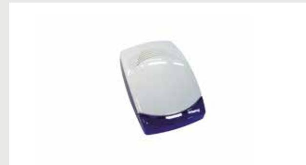
Sirena piezoelettrica con flash a LED da interno a basso profilo per impianti antintrusione. Livello sonoro di uscita 115dB. Tono di uscita programmabile: continuo o alternato. Conforme EN50131 grado 3 classe ambientale II. Tamper di protezione antiapertura e antirimozione.
