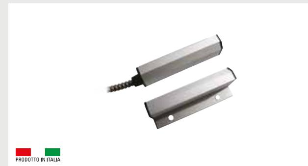
Contatto magnetico per superficie di grande portata conforme con la normativa europea EN50131-2-6 grado 2 classe ambientale IV. Contatto N.C. con anta chiusa. Contenitore in alluminio di elevata resistenza agli urti, per l'installazione su porte e serramenti in materiali ferromagnetici e non. Collegamento con cavo a 4 fili di lunghezza 100 cm protetto da guaina in acciaio.
