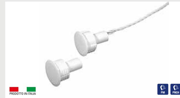
Contatto magnetico di sicurezza in ABS da incasso per infissi in materiali ferromagnetici e non. Conformità con la norma europea EN50131-2-6 grado 3 classe ambientale IV. Protezione continua contro le manomissioni magnetiche in serie al tamper 24h. Contatto N.C. con anta chiusa, collegamento 4 fili 30cm.
