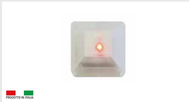
Ripetitore ottico a basso assorbimento ed ampio spettro di tensioni in ingresso: 3/30Vcc 2mA a luce fissa. Ideale come ripetitore per i rivelatori di fumo. Installazione in interni. Contenitore in policarbonato trasparente, connessione a morsetto.
