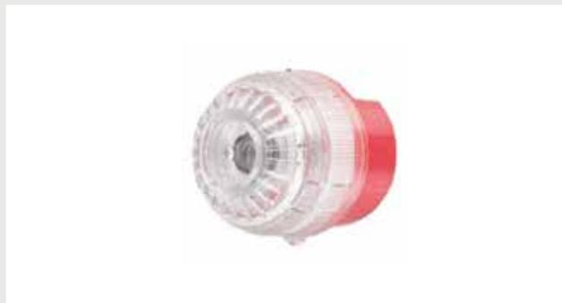
Lampeggiante elettronico LED a sicurezza intrinseca per l'uso in atmosfere potenzialmente esplosive, grado di protezione IP66, lampeggiante a 1Hz o fisso. Installazione rapida e semplice. ATEX, IECEx. Gruppo I MI Exia I Ma. Gruppo II IGD Exia IICT6 Ga Exia IIIC T850 C Da. Zone 0, 1, 2, 20, 21 e 22. Diodo polarizzato e resistenza fine linea.
