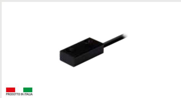
Sensore inerziale da superficie per la protezione di infissi in qualsiasi materiale. Corpo in alluminio anodizzato nero a basso profilo per installazioni in spazi ridotti. Linea tamper indipendente. Necessita di circuito di analisi per contatti veloci.
