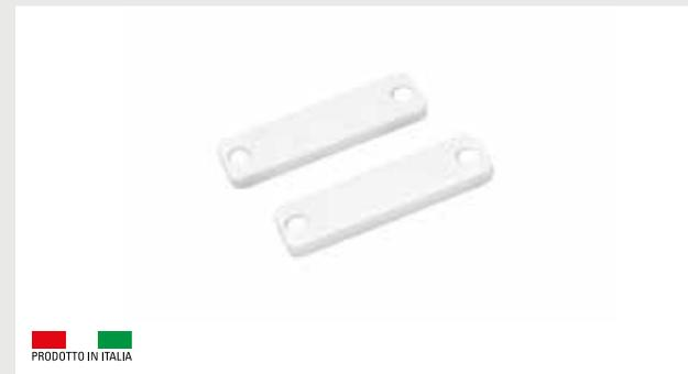
Contatto magnetico per superficie di grande portata conforme con la normativa europea EN50131-2-6 grado 2 classe ambientale II. Contatto N.C. con anta chiusa. Contenitore plastico sottile a basso profilo per l'installazione su porte in materiali ferromagnetici e non. Collegamento con cavo a 4 fili di lunghezza 1m. Disponibile anche in altri colori.
