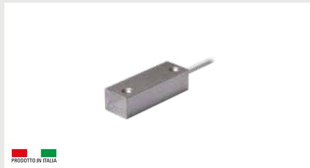
Doppia funzione integrata: contatto magnetico e sensore di vibrazione passivo indipendente. Rilevazione di tentativi di apertura e di sfondamento. Adatto per installazione anche su materiali ferromagnetici in posizione verticale con cavo di uscita verso l'alto. Necessita di scheda di analisi per contatti veloci tipo UTKSA02.
