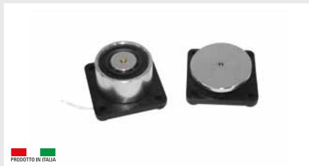
Fermo elettromagnetico per porte tagliafuoco. Certificazione EN1155. Forza di ritenuta 50Kg. Alimentazione 24Vcc 60mA.
