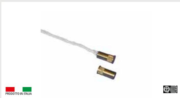
Mini-contatto magnetico di media portata omologato IMQ con la norma europea EN50131-2-6 grado 2 classe ambientale IV. Contatto N.C. con anta chiusa. Studiato per l'installazione su serramenti non ferromagnetici a basso profilo. Contenitore in ottone con parte terminale zigrinata per un fissaggio stabile nel profilo del serramento. Diametro foro di fissaggio 6 mm. Collegamento con 4 fili di uscita di lunghezza 30 cm.
