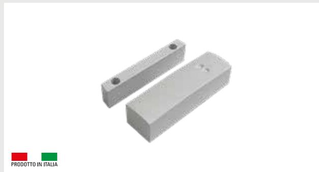
Contatto magnetico da superficie per interni in ABS bianco per infissi in materiali ferromagnetici e non. Conformità con la norma europea EN50131-2-6 grado 2 classe ambientale II. Contatto N.C. con anta chiusa, connessione a morsetti protetti da tamper.
