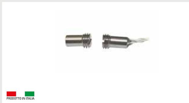
Contatto magnetico di media portata conforme con la norma europea EN50131-2-6 grado 2 classe ambientale IV. Contatto N.C. con anta chiusa. Studiato per l'installazione su serramenti non ferromagnetici particolarmente adatto per serramenti in legno grazie alla parte terminale filettata con taglio a cacciavite. Contenitore in ottone che, una volta installato, ha l'aspetto di una testa di vite. Diametro foro di fissaggio 10mm. Collegamento con 4 fili di uscita di lunghezza 30cm.
