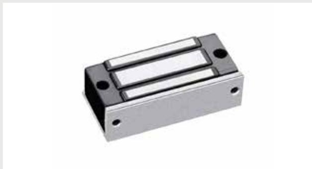
Chiusura elettromagnetica per superficie da 70Kg, in alluminio anodizzato, ideale per installazione su armadi e vetrine. Dimensioni 90Lx36.5Px24H(mm) - Contropiastra 75Lx32Px10H(mm). Tensione di alimentazione DC 12V o DC 24V. Temperatura di funzionamento -10°C/+55°C.
