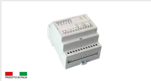
Modulo di distribuzione e controllo per protezione aggiuntiva per carichi e batterie tramite fusibile e relè nelle stazioni della serie AL-SIP. Allarmi di presenza rete e batteria bassa con relè in scambio a sicurezza attiva. Relè di stacco batteria a fine carica a protezione dalla scarica profonda. Montaggio a guida DIN.
