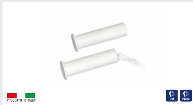
Contatto magnetico di sicurezza in ABS da incasso per infissi in materiale non ferromagnetico. Conformità con la norma europea EN50131-2-6 grado 3 classe ambientale IV. Protezione continua contro le manomissioni magnetiche in serie al tamper 24h. Contatto N.C. con anta chiusa, collegamento 4 fili 30cm.
