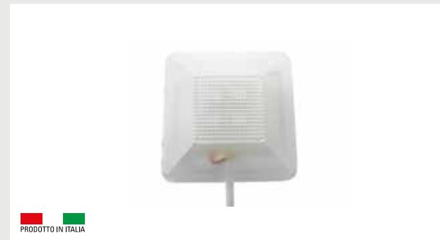
Ripetitore ottico con LED ad alta intensità per installazione in interni o esterni riparati. Ottima visibilità anche in condizioni di luce diurna. Illuminazione fissa o lampeggiante selezionabile con ponticello. Alimentazione 12/24Vcc con basso assorbimento. Connessione a morsetto 2 poli. Disponibile in 5 colori: rosso, giallo, verde, blu e bianco. Contenitore in policarbonato trasparente.
