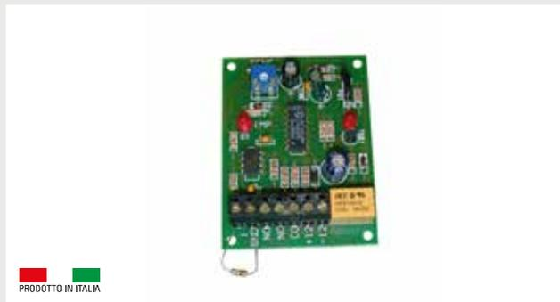
Circuito di analisi per sensori inerziali. Max 5 sensori per circuito. Alimentazione 12Vcc. Relè di allarme. Linea di ingresso bilanciata. Trimmer di regolazione sensibilità.
