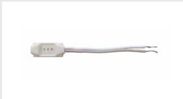
Ripetitore ottico miniaturizzato ad alta intensità Mini LED ad alta intensità per interni / esterni IP65. Elevata visibilità anche in condizioni di luce diurna. Illuminazione fissa, alimentazione 12Vcc 20mA. Disponibile nei colori rosso, verde, blu e bianco. Fissaggio facilitato con biadesivo posteriore preapplicato.
