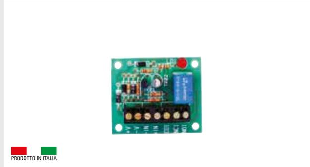
Circuito di interfaccia relè 12Vcc 3A amplificato in corrente per l' utilizzo con uscite di tipo open collector. Ingresso a comando positivo o negativo.
