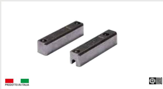
Contatto magnetico per superficie di grande portata omologato IMQ con la normativa europea EN50131-2-6 grado 2 classe ambientale II. Contatto N.C. con anta chiusa. Contenitore in alluminio pressofuso di elevata resistenza per l'installazione su porte in materiali ferromagnetici e non. Disponibile anche nella versione con contatto di scambio. Nella confezione sono inclusi tappi anti-rimozione delle viti di fissaggio. Collegamento con morsetti per contatto di allarme e tamper.
