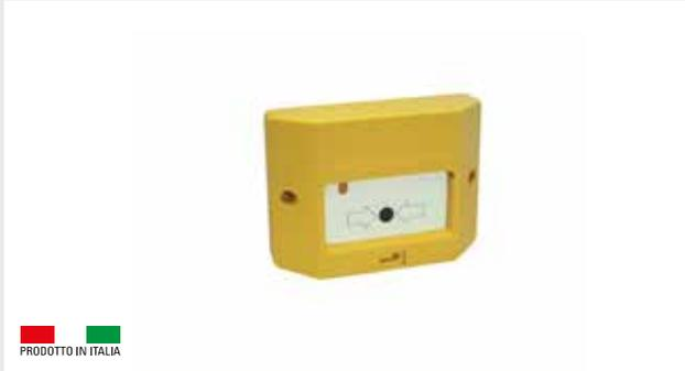
Pulsante di allarme a pressione con meccanismo di ripristino a chiave. Corpo in materiale plastico di colore GIALLO. Adatto all'installazione su scatole modulari da incasso. 1 Contatto di allarme in scambio. LED di memoria allarme. Morsetti di collegamento. Per colori differenti sostituire la G con R=rosso /V=verde.
