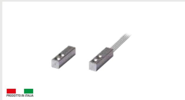
Contatto magnetico in miniatura per superficie di media portata conforme con la normativa europea EN50131-2-6 grado 2 classe ambientale IV. Contatto N.C. con anta chiusa. Contenitore in alluminio di elevata resistenza per l'installazione su porte e serramenti non ferromagnetici. Collegamento con 4 fili di lunghezza 30 cm.
