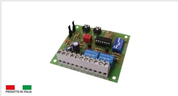
Circuito relè multi timer a microcontrollore ad 8 funzioni programmabili: doppia segnalazione temporizzata, relè amplificati, impulso monostabile, segnalazione a doppia temporizzazione con memoria, segnalazione su ingressi in AND in finestra temporale e segnalazione a fine conta impulsi con abilitazione. Uscite relè 3A 28Vcc/120Vca. Temporizzazioni 0-60 secondi o 0-60 minuti regolabili.
