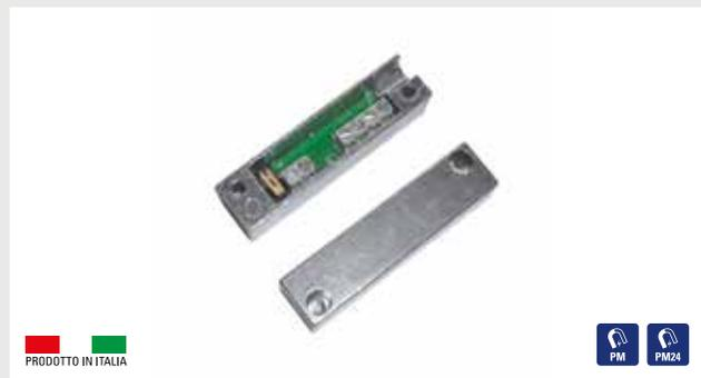
Contatto magnetico di sicurezza in alluminio pressofuso da superficie per infissi in materiali ferromagnetici e non. Conformità con la norma europea EN50131-2-6 grado 3 classe ambientale II. Contatto ausiliario indipendente integrato per domotica, controllo accessi o altro. Protezione continua contro le manomissioni magnetiche in serie al tamper 24h. Contatti N.C. con anta chiusa, collegamento a morsetto 6 poli. Tamper anti-rimozione su parte reed.
