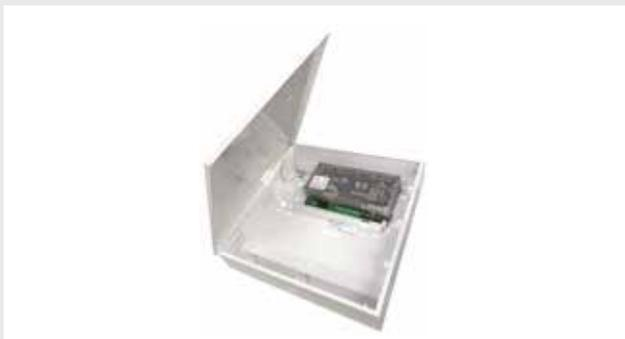
Stazione di alimentazione per sistemi antincendio certificata EN54-4. Tecnologia switching con monitoraggio intelligente della batteria. Remotizzazione degli allarmi con contatti liberi e segnalazione LED per mancanza rete, guasto batteria, guasto caricabatteria e guasto in uscita. Protezione della batteria contro le scariche profonde.
