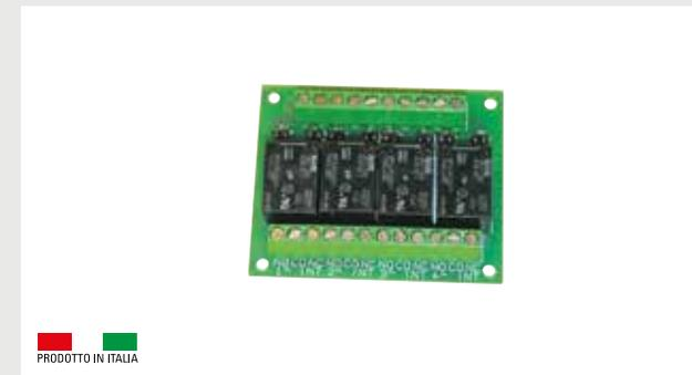
Circuito di interfaccia a 4 relè di scambio 10A. Tensione di funzionamento 12Vcc. Ponticelli di programmazione permettono di riferire i circuiti di pilotaggio alla tensione di ingresso positiva o negativa. Corrente minima di assorbimento 34mA per circuito.
