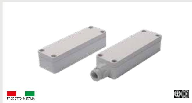
Contatto magnetico di sicurezza per esterni. Contenitore in alluminio pressofuso verniciato adatto ad installazione in esterno: protezione IP65. Tamper antistrappo per parte contatto e parte magnete. Conformità con la normativa europea EN50131-2-6 grado 2 classe ambientale IV.
