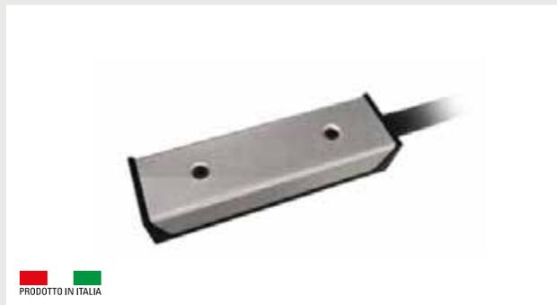
Circuito di controllo per rivelatore di liquidi professionale. Da abbinare a sonde di tipo UTKLDP11S. Alimentazione 12-24Vcc / 24Vac. Relè di allarme allo stato solido. Ingresso di test e di inibizione. Può gestire fino a 3 sonde con cavo da 10m oppure 2 sonde con cavo da 20m. Pilotaggio sonde in AC per evitare l'idrolisi. Connessione a morsetto. Sensibilità <25Kohm.
