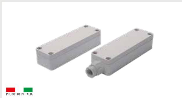
Contatto magnetico a grande distanza di funzionamento per esterni. Contenitore in alluminio pressofuso verniciato adatto ad installazione in esterno anche su materiali ferromagnetici: protezione IP65. Conformità con la normativa europea EN50131-2-6 grado 2 classe ambientale IV.
