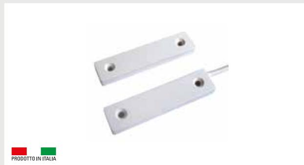
Contatto magnetico per superficie di grande portata conforme con la norma europea EN50131-2-6 grado 2 classe ambientale II. Profilo estremamente ridotto sottile e stretto, adatto anche per installazioni su infissi in materiale ferromagnetico. Contatto N.C. con anta chiusa, cavo di collegamento 4 poli 1m. Disponibile in vari colori. Fornito con biadesivo.
