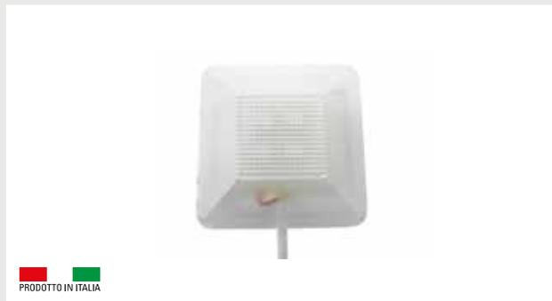
Ripetitore ottico da esterno IP65 con tecnologia LED RGB che permette la scelta del colore desiderato combinando i tre ingressi con negativo a dare. Regolatore di corrente integrato che permette di alimentare il dispositivo da 10,5Vcc a 27,6Vcc senza variazioni di luminosità. Versioni lampeggianti o a luce fissa.
