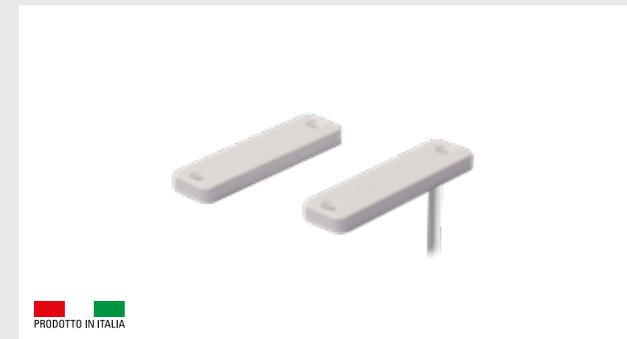
Sensore magnetico da superficie protetto dalle sovratensioni, adatto al pilotaggio di carichi induttivi come relè o motori con i limiti dettagliati nelle caratteristiche elettriche. Profilo piatto di 5mm per installazioni anche tra anta e stipite su serramenti ferromagnetici e non. Involucro in ABS in varie colorazioni, connessione cavo 4 poli di varie lunghezze.
