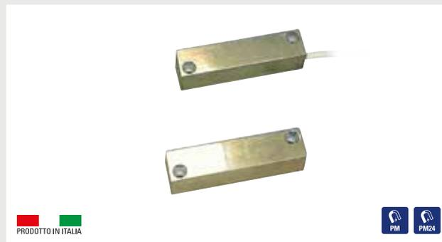
Contatto magnetico di sicurezza in alluminio pressofuso da superficie per infissi in materiali ferromagnetici e non. Conformità con la norma europea EN50131-2-6 grado 3 classe ambientale IV. Protezione continua contro le manomissioni magnetiche in serie al tamper 24h. Contatto N.C. con anta chiusa, cavo di collegamento 4 poli 150cm.
