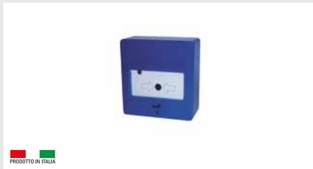
Pulsante di allarme a pressione con meccanismo di ripristino a chiave. Corpo in materiale plastico di colore blu. Contatto di allarme in scambio, LED di memoria allarme e collegamento a morsetti. Per colori differenti sostituire la B con W=bianco, G=giallo o V=verde.
