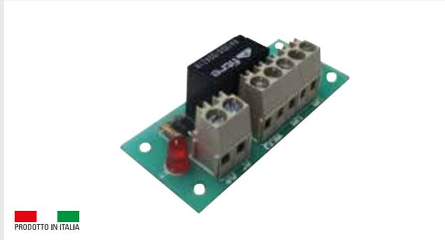
Circuito con relè di scambio 3A 250Vac. Tensione di funzionamento 12Vcc. Led di segnalazione di attivazione del relè. Corrente di assorbimento 42,5mA.
