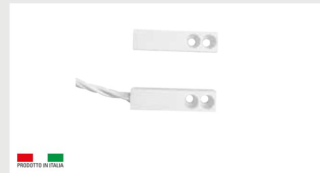
Contatto magnetico in miniatura per superficie di media portata conforme con la normativa europea EN50131-2-6 grado 2 classe ambientale IV. Contatto N.C. con anta chiusa. Contenitore plastico bianco per l'installazione su porte e serramenti non ferromagnetici. Collegamento con 4 fili di lunghezza 30 cm.
