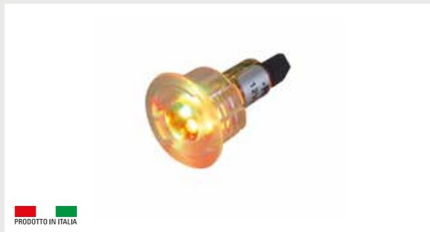
Ripetitore ottico con LED ad alta intensità per installazione ad incasso in interni o esterni riparati. Ottima visibilità anche in condizioni di luce diurna. Alimentazione 12Vcc con basso assorbimento luce fissa. Connessione a morsetto 3 poli. Disponibile in 6 versioni: rosso, giallo, verde, blu, bianco e bicolore rosso-verde. Contenitore in ABS trasparente.
