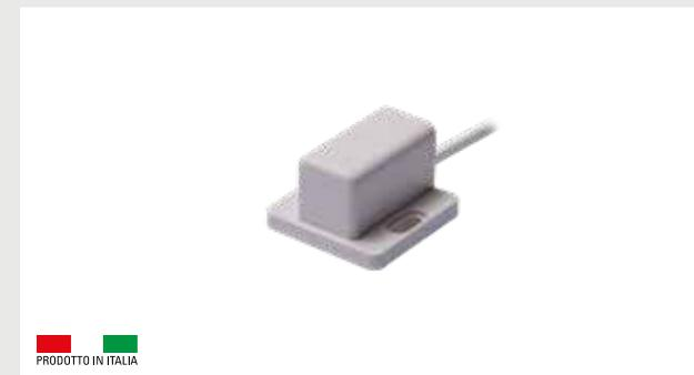
Sensore inerziale plastico per la protezione di vetrate e superfici in genere. Cavo di connessione a 4 poli. Installazione con fissaggio a vite o con biadesivo (in dotazione). Necessita di circuito di analisi per sensori veloci.
