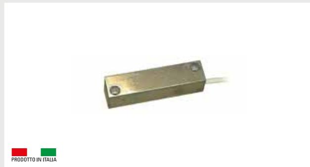
Sensore piezoelettrico inerziale da superficie per la protezione di infissi in qualsiasi materiale. Involucro in alluminio pressofuso. Non necessita ne di alimentazione ne di circuiti di analisi risultando particolarmente indicato per sistemi via radio. Alla rilevazione dell'allarme il contatto si apre per un tempo che va da 2 a 30 sec. in base alla sollecitazione ricevuta. Disponibile anche nella versione con contatto magnetico integrato.
