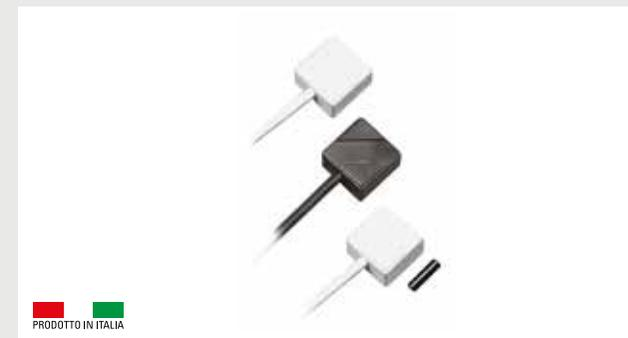
Sensore piezoelettrico inerziale da superficie per la protezione di infissi in qualsiasi materiale. Involucro plastico di dimensioni particolarmente ridotte. Non necessita né di alimentazione né di circuiti di analisi risultando particolarmente indicato per sistemi via radio. Alla rilevazione dell'allarme il contatto si apre per un tempo che va da 2 a 30 sec. in base alla sollecitazione ricevuta. Disponibile anche nella versione con contatto magnetico integrato.
