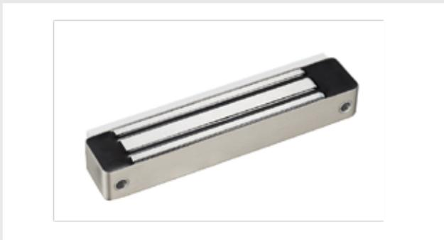
Chiusura elettromagnetica impermeabile 180kg IP68 con stato porta. Ideale per installazione in superficie su porte in legno, metallo, vetro, porte scorevoli e porte tagliafuoco. Dimensioni 175Lx39.5Px26.5H(mm) Contropiastra 130Lx32x10H(mm). Tensione di alimentazione DC 12V o DC 24V. Temperatura di funzionamento -30~+66°C.
