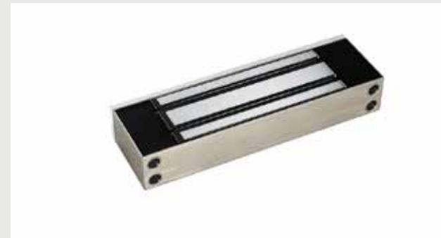
Chiusura elettromagnetica impermeabile 500kg IP68 con stato porta. Ideale per installazione in superficie su porte in legno, metallo, vetro, porte scorevoli e porte tagliafuoco. Dimensioni 230Lx72Px37.8H(mm) Contropiastra 185Lx60x13.2H(mm). Tensione di alimentazione DC 12V o DC 24V. Temperatura di funzionamento -30~+66°C
