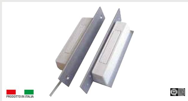
Versione da incasso del UTKCHP01, contatto magnetico di altissima sicurezza da interno a triplo bilanciamento magnetico. I campi magnetici concatenati rendono il contatto estremamente sicuro contro i tentativi di manomissione magnetica. Omologazione IMQ con la norma europea EN50131-2-6 grado 3 classe ambientale II. Contenitore in ABS caricato bianco. Contatto N.C. con anta chiusa, connessione a morsetti protetti da tamper.
