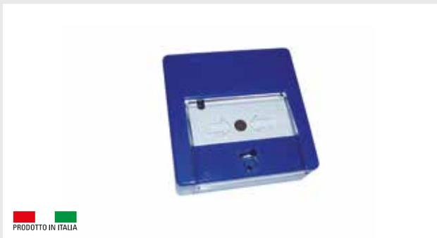
Pulsante di allarme a pressione con meccanismo di ripristino a chiave. Sportello di protezione trasparente anti attivazione accidentale. Corpo in materiale plastico di colore blu. Contatto di allarme in scambio, LED di memoria allarme e collegamento a morsetti. Per colori differenti sostituire la B con W=bianco, G=giallo o V=verde.
