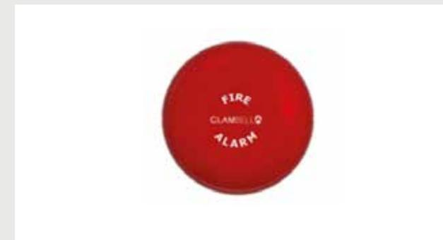
Campana antincendio diametro 150 mm in versione per esterni. Grado di protezione IP56. Gong in alluminio per elevata resa acustica e maneggevolezza. Alimentazione 24Vcc 12mA. Certificazione CPR EN54-3. Fornita con scatola di giunzione per il montaggio a muro e 2 pressacavi.
