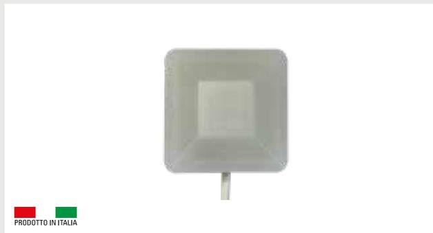
Ripetitore ottico con led di grande potenza per installazione in esterni. Contenitore in policarbonato opale a diffusione uniforme. Grado di protezione IP65. Ottima visibilità anche in condizioni di luce diurna. Illuminazione fissa. Alimentazione 12/24Vcc con basso assorbimento. Disponibile in 5 colori: Rosso, Giallo, Verde, Blu, Bianco. Contenitore in policarbonato trasparente. Cavo di collegamento.
