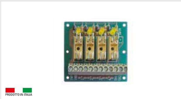
Circuito distribuzione e sezionamento tensioni. Consente di dividere e proteggere 4 linee di alimentazione ognuna con fusibile. Segnalazione Led rottura fusibile (con carico connesso). Forniti senza fusibili.
