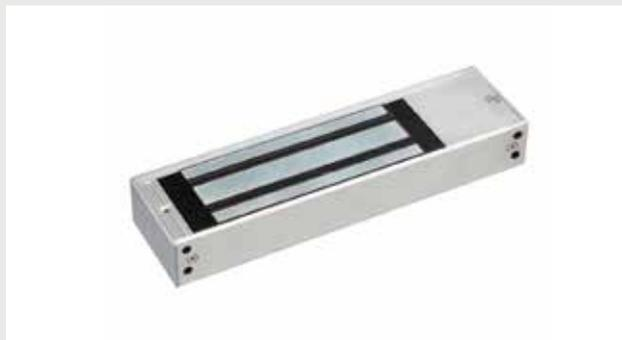
Chiusura elettromagnetica per superficie da 500Kg in alluminio anodizzato. Ideale per installazione su porte in legno, metallo, vetro e porte tagliafuoco. Dimensioni 265Lx73Px41H (mm) - Contropiastra 185Lx60Px13.2H (mm). Tensione di alimentazione DC 12V o DC 24V. Temperatura di funzionamento -20°C/+55°C.
