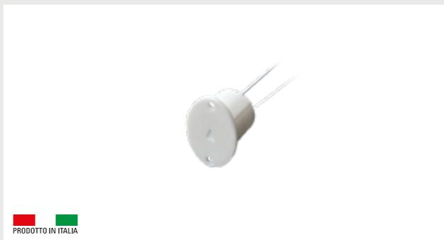
Sensore inerziale elettromeccanico passivo da esterno per installazione in incasso su serramenti in posizione orizzontale. Contenitore plastico adatto al fissaggio su alluminio, plastica, legno o infissi in materiale ferromagnetico. Necessita scheda di analisi per contatti veloci
