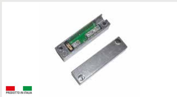
Sensore magnetico per superficie in alluminio pressofuso con 2 contatti NC indipendenti. Adatto a infissi in materiale ferromagnetico e non. Contatto ausiliario indipendente integrato per domotica, controllo accessi o climatizzazione. Versione con morsetto 6 poli e tamper anti-rimozione. Viti per il fissaggio e tappi copri vite a pressione compresi.
