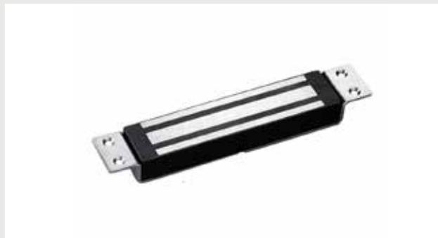
Chiusura elettromagnetica da incasso da 180kg, con segnalazione stato porta con contatto reed. Ideale per installazione su porte in Legno, Metallo e porte tagliafuoco. Dimensioni 190Lx31,5Px22,5H(mm) - Contropiastra 130Lx33x9,3H(mm). Tensione di alimentazione DC 12V o DC 24V. Temperatura di funzionamento -10°C/+55°C.
