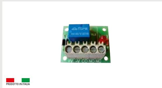
Circuito con relè di scambio 3A. Tensione di funzionamento 12vcc. Led di segnalazione di attivazione del relè. Corrente minima di assorbimento 23mA.
