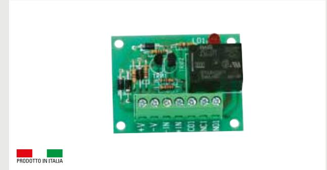
Circuito di interfaccia relè 12Vcc 10A amplificato in corrente per l' utilizzo con uscite di tipo open collector. Ingresso a comando positivo o negativo.
