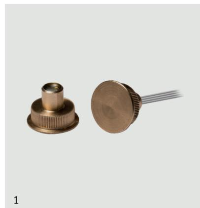
Evoluzione del modello CTI102 con un profilo ribassato che consente una installazione anche su serramenti con telaio ridotto. La conformazione con una ghiera alettata finemente, consente l'installazione praticando un foro diametro 20 mm che preserva la capacità magnetica del sensore e permette di mantenere distanze di funzionamento fino a 20 mm.
