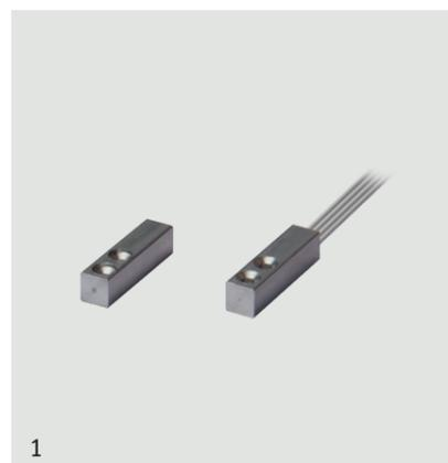
Sensore magnetico di dimensione estremamente contenute con solo 6mm di spessore e 25mm di lunghezza per installazioni discrete. Disponibile anche nella versione con cavo con guaina 4 conduttori. La distanza di funzionamento minima garantita è di 10 mm. Fissaggio realizzato tramite 4 viti autofilettanti (di serie).
