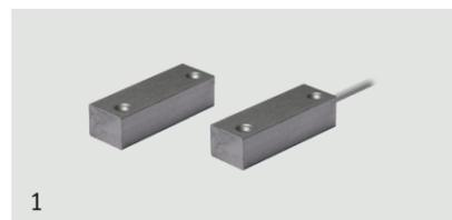
Sensore magnetico adatto a serramenti ferromagnetici. Superficie trattata con finitura anodizzata in alluminio naturale o marrone per adattarsi a porte in ferro o blindate. Cavo di collegamento da 150cm. Distanza di funzionamento di 25 mm in aria libera, funzionamento ottimale su tutte le superfici.
