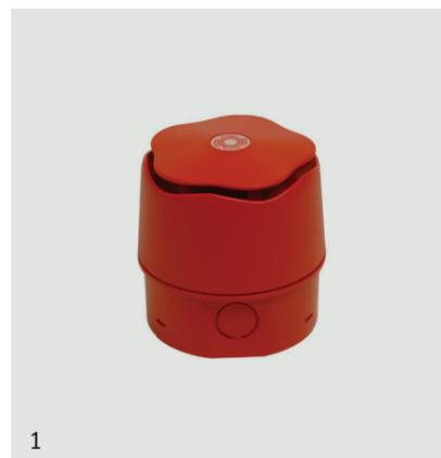
Sirene elettroniche multisuono a 32 toni selezionabili, omologate secondo EN54-3, per l'installazione in impianti di rilevazione incendio. Montaggio a baionetta su base alta per esterni (IP66) o bassa, per interni (IP45) per parete o superficie.
