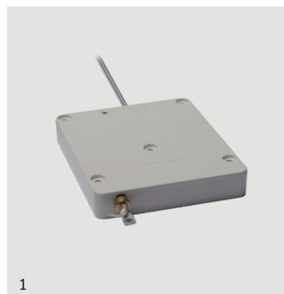
Sensore a filo per tapparelle, boccola di scorrimento cordina in ottone smussato, 5 punti di fissaggio per installazione facilitata. Struttura particolarmente robusta per massima affidabilità nel tempo. Connessione a 2 conduttori (CTF001V) o a morsetto (CTF001VM). Necessità di scheda di analisi per sensori veloci (CTFA001 o CTFA011LP).
