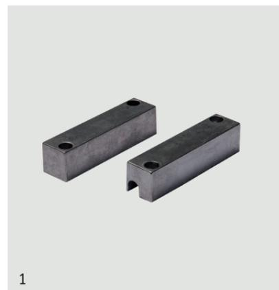
Sensore magnetico per installazione a vista su serramenti in ferro. Collegamento a morsetto 5 poli. Tamper anti-rimozione e morsetto dedicato al collegamento di una resistenza di bilanciamento linea. Nella confezione sono comprese le viti per il fissaggio del contatto e tappi copri vite a pressione. Distanza di funzionamento di 25mm in aria libera.
