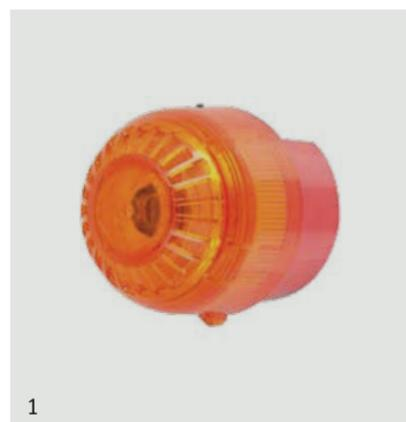
Sirena con lampeggiante per l'uso in atmosfere potenzialmente esplosive, grado di protezione IP66, 32 toni selezionabili, potenza fino a 105dB, lampeggiante a 1Hz o fisso. Installazione rapida e semplice. ATEX, IECEx. Gruppo I MI Exia I Ma. Gruppo II IGD Exia IIC T6 Ga Exia IIIC T850 C Da. Zone 0, 1, 2, 20, 21 e 22. Diodo polarizzato e resistenza fine linea.
