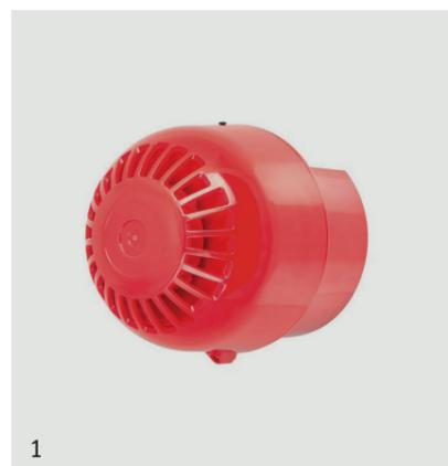
Sirena intrinsecamente sicura per l'uso in atmosfere potenzialmente esplosive, grado di protezione IP66. 32 toni selezionabili con potenza sonora fino a 105dB. Installazione rapida e semplice. ATEX, IECEx. Gruppo I MI Exia I Ma. Gruppo II IGD Exia IIC T6 Ga Exia IIIC T850 C Da. Zone 0, 1, 2, 20, 21 e 22. Diodo polarizzato e resistenza fine linea.
