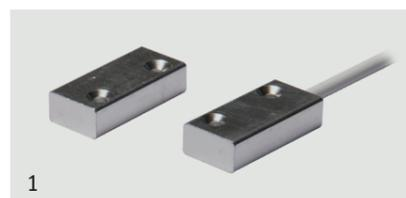
Doppia funzione integrata: contatto magnetico e sensore di vibrazione passivo indipendente. Rilevazione di tentativi di apertura e di sfondamento. Adatto per installazione su materiali non ferromagnetici in posizione verticale con cavo di uscita verso il basso. Necessita di scheda di analisi per contatti veloci tipo CSAI001, CSAI002 o CSAI011LP.
