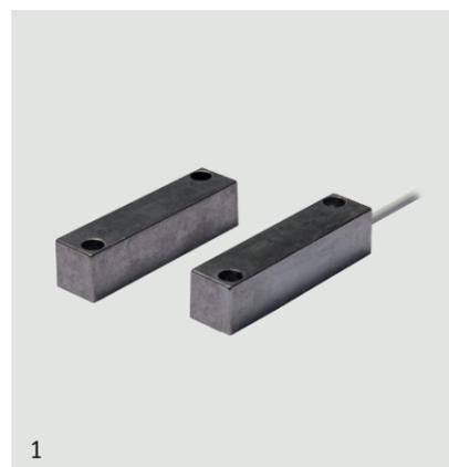
Sensore magnetico per superficie in alluminio pressofuso protetto dalle sovratensioni, adatto al pilotaggio di carichi induttivi come relè o motori con i limiti dettagliati nelle caratteristiche elettriche. Adatto a infissi in materiale ferromagnetico e non. Versione totalmente resinata per esterno o interno. Viti e tappi copri vite a pressione compresi.
