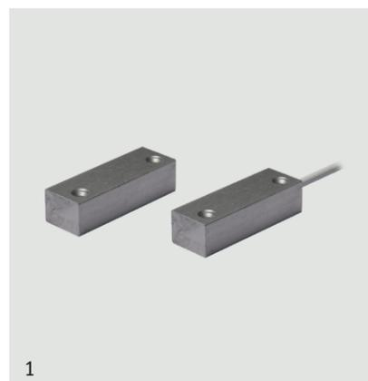
Sensore magnetico adatto a serramenti ferromagnetici. Superficie trattata con finitura anodizzata in alluminio naturale per adattarsi a porte in ferro o blindate. Cavo di collegamento da 150cm. Distanza di funzionamento di 30 mm in aria libera, funzionamento ottimale su tutte le superfici.
