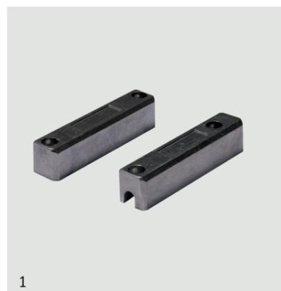
Sensore magnetico per installazione a vista su serramenti in ferro. Collegamento a morsetto 4 poli. Tamper anti-rimozione sulla parte reed. Nella confezione sono contenuti i tappi copri vite a pressione. Distanza di funzionamento di 30mm in aria libera.
