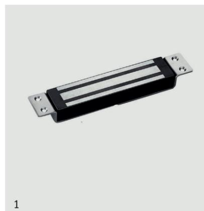
Elettromagneti per impianti di controllo accessi e di sicurezza con portata da 180 Kg a 300 Kg. Alimentazione 12Vcc o 24Vcc. Installazione da incasso. Grazie alla loro versatilità possono sostituire le tradizionali chiusure con serratura sulle porte di emergenza, mantenendo la sicurezza totale della chiusura e dell'apertura in caso di necessità.
