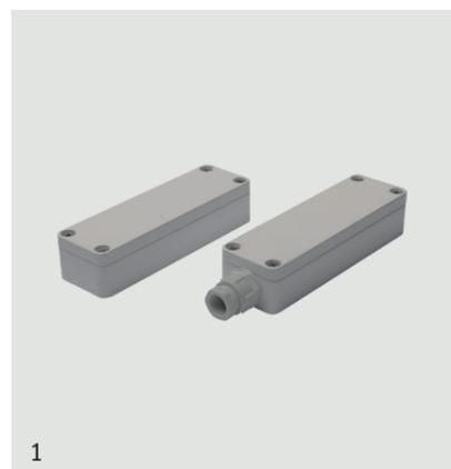
Contatto magnetico di altissima sicurezza brevettato. Versione a triplo bilanciamento magnetico con schermo magnetico per massima immunità ai tentativi di manomissione. Contenitore in alluminio pressofuso verniciato per esterni IP65. Adatto a serramenti ferromagnetici e non. Collegamento interno a morsetti protetti da tamper.
