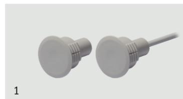
Doppia funzione integrata: contatto magnetico e sensore di vibrazione passivo indipendente. Rilevazione di tentativi di apertura e di sfondamento. Adatto anche per installazione su materiali ferromagnetici in posizione verticale con cavo di uscita verso l'alto. Necessita di scheda di analisi per contatti veloci tipo CSAI001, CSAI002 o CSAI011LP.
