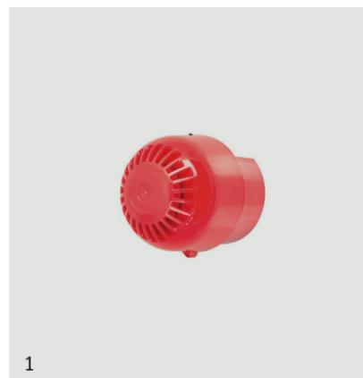
Lampeggiante elettronico LED a sicurezza intrinseca per l'uso in atmosfere potenzialmente esplosive, grado di protezione IP66, lampeggiante a 1Hz o fisso. Installazione rapida e semplice. ATEX, IECEx. Gruppo I MI Exia I Ma. Gruppo II IGD Exia IIC T6 Ga Exia IIIC T850 C Da. Zone 0, 1, 2, 20, 21 e 22. Diodo polarizzato e resistenza fine linea.
