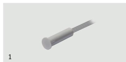
Sensore inerziale elettromeccanico passivo da incasso. Contenitore in ABS adatto al fissaggio su alluminio, plastica, legno o infissi in materiale ferromagnetico. Installazione in posizione verticale con cavo di uscita verso l'alto. Necessita di scheda di analisi per contatti veloci tipo CSAI001, CSAI002 o CSAI011LP.
