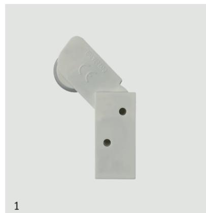
Sensore a rotella da installare a contatto con la tapparella ed in grado di seguirne il movimento. La rotella è montata su asta basculante per adattarsi al movimento della tapparella. Da collegare a scheda di analisi per sensori veloci (CTFA001 o CTFA011LP). Connessione a morsetto.
