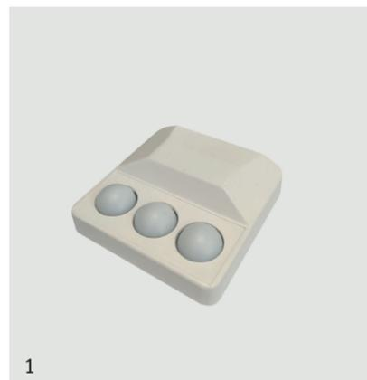
Ripetitore ottico acustico a Led di segnalazione con lente da 20 mm con ampia visibilità frontale e laterale per interni. Alimentazione a 12 o 24Vcc con regolazione interna automatica e basso assorbimento. Segnalazione fissa o lampeggiante selezionabile con comando remotizzabile. Disponibile con buzzer fisso o intermittente. Colore rosso, giallo, verde oppure rosso, verde.
