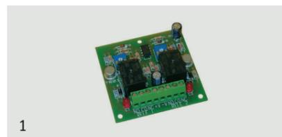
Circuiti di controllo e protezione tensione di uscita per batterie al piombo 12Vcc. Versione a 2 relè per controllo di sovratensione e scarica profonda o a 1 relè per controllo scarica profonda a protezione delle batterie.
