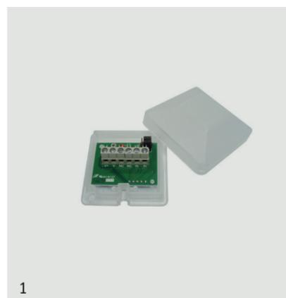
Scheda di analisi per sensori inerziali ad ampio range di tensione di alimentazione e basso assorbimento per adattabilità a trasmettitori wireless. Soglia di allarme regolabile al 100%, 125% o 150% del valore memorizzato in fase di taratura. Uscita relè allo stato solido N.C. aprè in allarme per 1 secondo circa.
