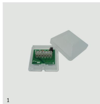
Analisi di contatti a fune con regolazione degli impulsi tramite ponticelli e rilevazione linea aperta. Ampio range di tensione di alimentazione e basso assorbimento per adattabilità con trasmettitori wireless. Uscita relè allo stato solido N.C. aprè in allarme per 1 secondo circa.
