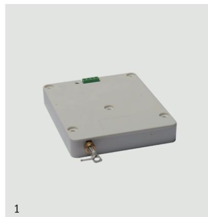
Sensore a filo per tapparelle, boccola di scorrimento cordina in ottone smussato, 5 punti di fissaggio. Doppio microswitch interno per massimizzare l'affidabilità e ridurre al massimo i falsi allarmi. Ampio range di tensione di alimentazione e basso assorbimento per adattabilità a trasmettitori wireless. Uscita relè allo stato solido.
