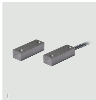
Sensore magnetico adatto a serramenti ferromagnetici con cavo protetto da guaina in acciaio flessibile anti-taglio. Superficie trattata con finitura anodizzata in alluminio naturale per adattarsi a porte in ferro o blindate. Cavo di collegamento da 150cm. Distanza di funzionamento di 30 mm in aria libera, funzionamento ottimale su tutte le superfici.
