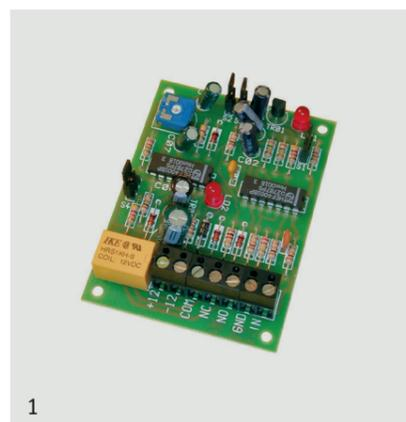
Analisi per tutti i tipi di contatto a fune per tapparella. Alta immunità ai falsi allarmi. Regolazione degli impulsi tramite ponticelli e regolazione della finestra temporale con trimmer. Relè di allarme programmabile per il funzionamento in normalmente attratto (NA) o normalmente rilasciato (NR). Led visualizzazione impulsi e led relè in allarme.
