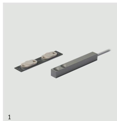
Sensore magnetico in contenitore di alluminio anodizzato per installazione a vista su avvolgibili e serramenti scorrevoli. Magnete dal profilo piatto (altezza 5 mm). Cavo di collegamento da 100 cm a 4 conduttori. La distanza di 40 mm in aria libera garantisce funzionamento ottimale su tutte le superfici.
