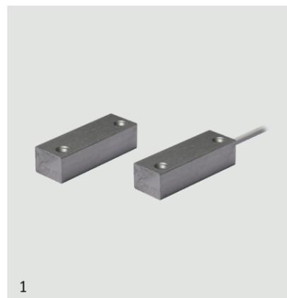
Doppia funzione integrata: contatto magnetico e sensore di vibrazione passivo indipendente. Rilevazione di tentativi di apertura e di sfondamento. Adatto per installazione anche su materiali ferromagnetici in posizione verticale con cavo di uscita verso il basso. Necessita di scheda di analisi per contatti veloci tipo CSAI001, CSAI002 o CSAI011LP.
