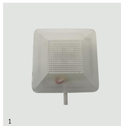
Ripetitore ottico da esterno multicolore 12/24Vcc fisso/lampeggiante. Protezione IP67 con tecnologia LED RGB che permette la scelta del colore desiderato combinando i tre ingressi con negativo a dare. Regolatore di corrente integrato che permette di alimentare il dispositivo da 10,5Vcc a 27,6Vcc senza variazioni di luminosità.
