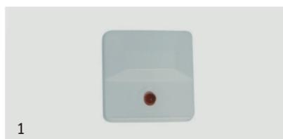
Rivelatore di liquidi per ambienti a rischio allagamento. Installazione in appoggio su pavimento. Dotato di relè di allarme; disponibile nelle versioni con led di segnalazione o con buzzer bitonale. Alimentazione da 12 a 27Vcc. Al rivelatore è possibile collegare una sonda per la rilevazione remota (KLD001S).
