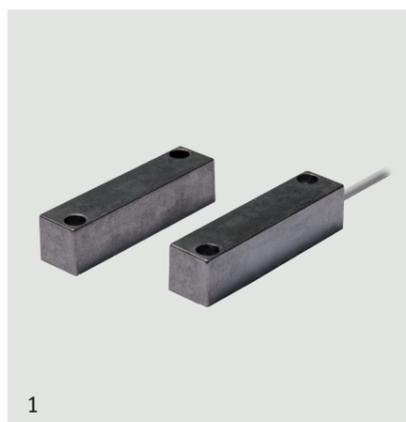
Sensore magnetico per superficie in alluminio pressofuso con 2 contatti NC indipendenti. Adatto a infissi in materiale ferromagnetico e non. Contatto ausiliario indipendente integrato per domotica, controllo accessi o climatizzazione. Versione con cavo 6 poli totalmente resinata per esterno o interno. Viti e tappi copri vite a pressione compresi.
