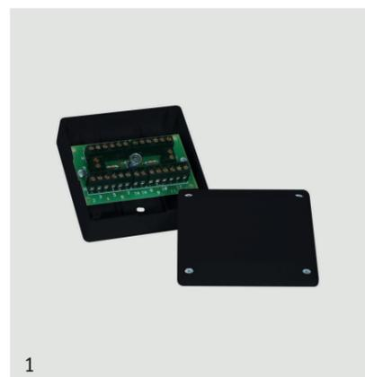
Scatola di giunzione autoprotetta a 28 poli con tamper contro l'apertura del coperchio. Il circuito di giunzione è composto da 2 ingressi ciascuno formato da 2 poli e collegati a 12 morsetti con sezione 1,5mmq. Il circuito è predisposto per il sezionamento tramite resistenze da OR.
