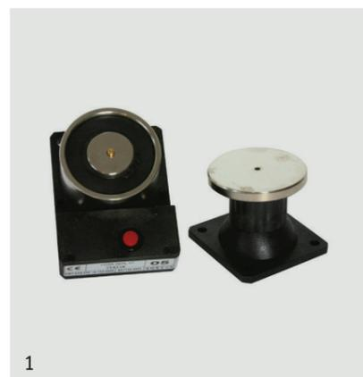
Serie di elettromagneti di ritenuta per porte tagliafuoco. Portata 50Kg o 100Kg, installazione a parete o a pavimento, con staffa opzionale. Rilascio automatico in caso di incendio. Pulsante di sgancio manuale incluso. Collegamenti via morsetto, protetto da diodo contro l'inversione della polarità e resistenza di limitazione.
