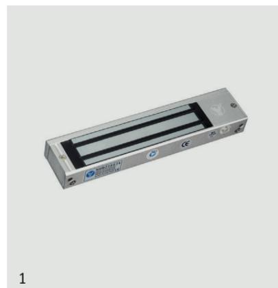
Elettromagneti IP68 per impianti di controllo accessi e di sicurezza con portata da 180Kg a 500Kg. Alimentazione 12Vcc o 24Vcc. Installazione per superficie. Grazie alla loro versatilità possono sostituire le tradizionali chiusure con serratura sulle porte di emergenza, mantenendo la sicurezza totale della chiusura e dell'apertura in caso di necessità.
