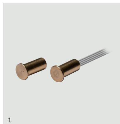
Sensore da incasso in ottone particolarmente robusto e adatto alla protezione di serramenti in legno, PVC e non ferromagnetici in generale. Il basso profilo di diametro e l'altezza di soli 18mm consente un'agevole installazione anche in spazi ridotti. Distanza di funzionamento garantita da 10mm. Disponibili versioni con uscita cavo di diverse metrature.
