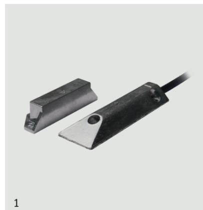
Sensore magnetico per installazione su porte basculanti e serrande in ferro. Contenitore in alluminio pressofuso ideale per installazione a pavimento. Il contatto è alto solo 15mm per consentire un agevole passaggio. Cavo a 4 conduttori protetto da una guaina in acciaio ricoperta da gomma nera.
