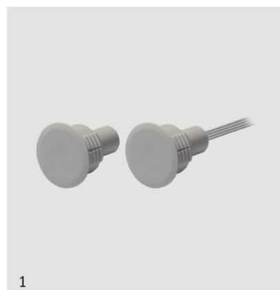
Sensore da incasso per porte blindate protetto dalle sovratensioni, adatto al pilotaggio di carichi induttivi come relè o motori con i limiti dettagliati nelle caratteristiche elettriche. Ghiera di fissaggio alettata e molleggiata consente l'installazione praticando un foro diametro 20 mm che preserva la capacità magnetica del sensore.
