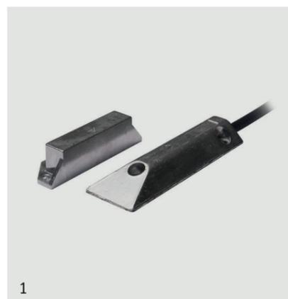
Sensore magnetico per installazione su porte basculanti e serrande in ferro. Realizzato in alluminio pressofuso è ideale per l'installazione a pavimento. Cavo di collegamento a 4 conduttori protetto da una guaina in acciaio spiralato rivestita. Protezione contro le manomissioni magnetiche in serie al tamper 24h per una protezione continua.
