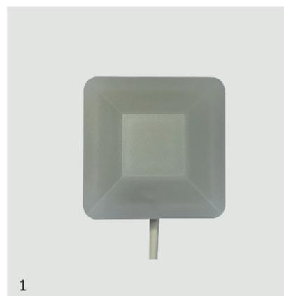
Ripetitore ottico da esterno multicolore 12/24Vcc fisso/lampeggiante. Contenitore in policarbonato opale a diffusione uniforme. Protezione IP67 con tecnologia LED RGB che permette la scelta del colore desiderato combinando i tre ingressi con negativo a dare. Regolatore di corrente integrato che permette di alimentare il dispositivo da 10,5Vcc a 27,6Vcc senza variazioni di luminosità.
