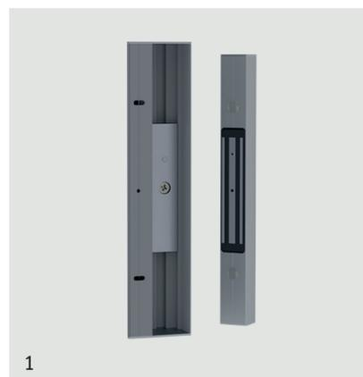
Dispositivo di chiusura elettromagnetica con maniglia estetica di copertura in alluminio. Profilo quadrato fissato a telaio e profilo maniglia fissato al battente con contropiastra regolabile nascosta all'interno. Contatto di stato porta su tutti i modelli. Tensione di alimentazione a 12Vcc o 24Vcc selezionabile.
