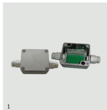
Scatola di giunzione in alluminio sabbiato 6 poli indipendenti + 2 poli di tamper; da esterno. Viti di fissaggio protette, viti coperchio imperdibili, 2 pressatubi PG9.
