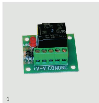
Circuito di interfaccia relè 12Vcc 10A per l'accoppiamento di circuiti di uscita a basse correnti che debbano pilotare carichi di potenza. L'unità è composta da 1 relè che pilota, tramite un contatto di scambio, il proprio carico. L'accensione del led indica l'eccitazione del relè. Disponibile anche nella versione con relè a 24Vcc (C1RE006).
