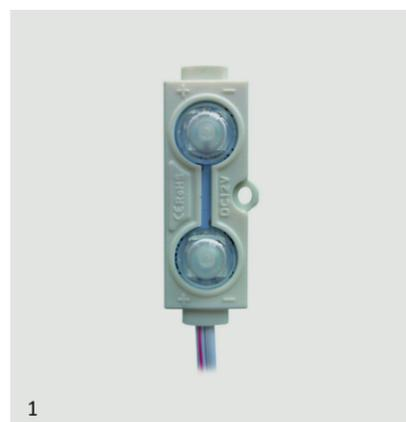
Ripetitore ottico a LED alta intensità da esterni IP65. Ottima visibilità anche in condizioni di luce diurna. Illuminazione fissa, alimentazione 12Vcc 40mA. Disponibile nei colori rosso, verde, blu e bianco. Fissaggio facilitato con biadesivo posteriore pre-applicato.
