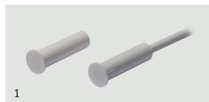
Sensore da incasso ideale per la protezione di serramenti in alluminio e non ferromagnetici in generale. Contatto reed ausiliario indipendente per gestione di sistemi diversi come controllo accessi o climatizzazione. Il corpo plastico è dotato di una serie di alette che consentono un accoppiamento perfetto tra rivelatore e superficie di installazione.
