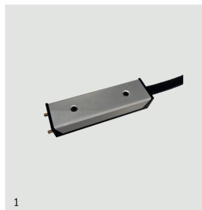
Rivelatore di liquidi per ambienti a rischio allagamento IP67 stand alone. Sensibilità fino a 25Kohm, pilotaggio puntali in a.c. per eliminare l'idrolisi. Connessione a cavo 8 poli con guaina in acciaio spiralato rivestito in gomma nera da 1m. Linea di test remoto e ingresso di inibizione. Alimentazione 12Vcc, 24Vcc o 24Vac.
