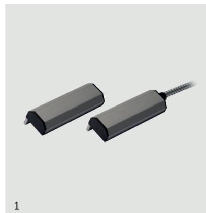
Sensore magnetico in alluminio anodizzato naturale per installazione a vista su serramenti ferromagnetici e non con cavo inguainato in tubo spiralato flessibile anti-taglio. Aletta di fissaggio per installazione a sbalzo o a semi incasso. Cavo 100cm 4 conduttori, distanza di funzionamento 50mm in aria libera per funzionamento ottimale su tutte le superfici.
