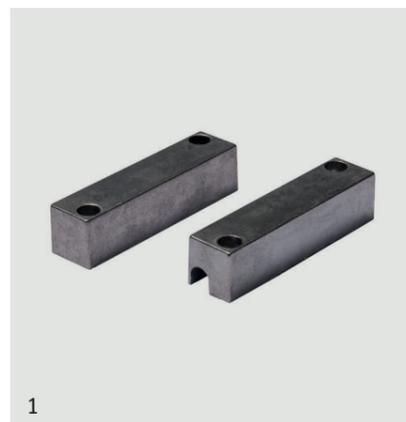
Contatto di sicurezza in alluminio pressofuso da superficie per materiali ferromagnetici e non. Conformità EN50131-2-6 grado 3 classe ambientale II. Contatto ausiliario indipendente integrato per domotica, controllo accessi. Collegamento a morsetto 6 poli. Tamper anti-rimozione su parte reed.
