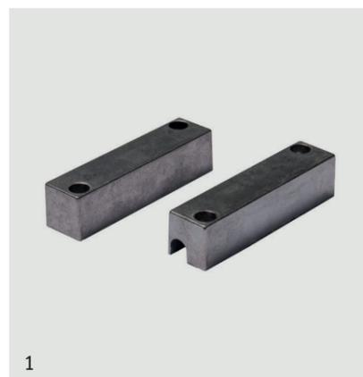
Sensore magnetico per superficie in alluminio pressofuso con 2 contatti NC indipendenti. Adatto a infissi in materiale ferromagnetico e non. Contatto ausiliario indipendente integrato per domotica, controllo accessi o climatizzazione. Versione con morsetto 6 poli e tamper anti-rimozione. Viti per il fissaggio e tappi copri vite a pressione compresi.
