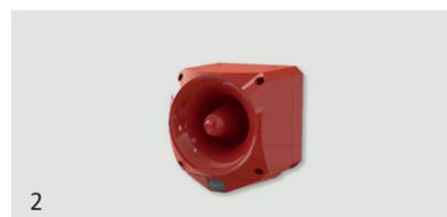
Nexus è una linea di sirene di potenza da 105dB a 120dB e con alimentazione da 17Vcc a 60 Vcc certificata EN54-3 e EN54-23. Robuste e potenti sono ideali per l'installazione in ambienti industriali e dove il rumore di fondo è particolarmente elevato. Grado di protezione IP66. Toni di allarme programmabili e selezionabili.
