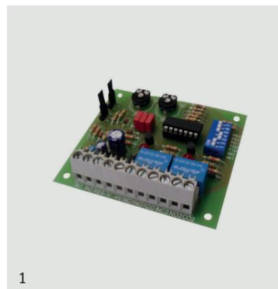
Scheda temporizzata 8 funzioni: doppia segnalazione temporizzata, da impulsivo a bistabile e da bistabile a impulsivo, impulso monostabile, segnalazione doppia temporizzazione con memoria, segnalazione preallarme temporizzato e allarme immediato, relè passo passo temporizzato, segnalazione su ingressi in AND in finestra temporale e conta impulsi con abilitazione.
