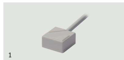
Sensore piezoelettrico sismico di ridotte dimensioni. Particolarmente indicato nei sistemi via radio perché non necessita né di alimentazione né di analisi, quando è in allarme apre il circuito per un tempo che va da 2 a 30 sec. in base alla sollecitazione ricevuta. Versione con contatto magnetico integrato in serie. Involucro in ABS bianco o marrone.
