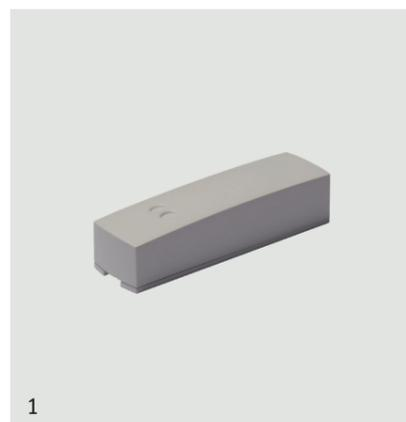
Rivelatore di impatto e vibrazioni con analisi del segnale a microprocessore. Adatto a tutte le superfici con orientamento a 360° sui 3 assi. Il sensore MEMS permette un'accurata rilevazione del segnale su tutti e tre gli assi spaziali. Il microprocessore completa l'analisi filtrando, integrando nel tempo e combinando i diversi contributi sui tre assi.
