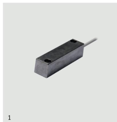
Sensore piezoelettrico sismico in contenitore metallico da esterno. Particolarmente indicato nei sistemi via radio perché non necessita né di alimentazione né di analisi, quando è in allarme apre il circuito per un tempo che va da 2 a 30 sec. in base alla sollecitazione ricevuta. Versione con contatto magnetico integrato in serie o indipendente.
