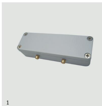
Rivelatore di liquidi per ambienti a rischio allagamento. Installazione a parete o a pavimento con staffa di fissaggio (a richiesta). Circuito interno di analisi che evita l'idrolisi dei contatti grazie ad un oscillatore. Relè di allarme allo stato solido. Alimentazione 12Vcc, 24Vcc o 24Vac. Grado di protezione IP67.
