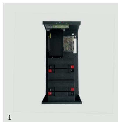
Stazione caricabatteria in tampone a 48Vcc per fornire autonomia a sistemi di videosorveglianza Poe. Le unità possono essere dotate di switch Poe da 4 o 8 canali. Il contenitore può alloggiare fino a 4 batterie al piombo da 12V 18Ah per garantire una buona autonomia al sistema Poe.
