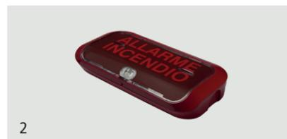
Targa ottico-acustica di allarme incendio. LED ad alta luminosità bianco con sincronia. Cono piezo a basso assorbimento con tono di preallarme e allarme selezionabile con ingresso dedicato. Meccanica robusta e gradevole con possibilità di montaggio a semi-incasso. Modalità a basso assorbimento e possibilità di tacitare la parte acustica.
