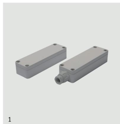
Contatto magnetico di alta sicurezza. Versione a doppio bilanciamento magnetico per alta immunità ai tentativi di manomissione. Contenitore in alluminio pressofuso verniciato per esterni IP65. Adatto a serramenti ferromagnetici e non. Collegamento interno a morsetti protetti da tamper.
