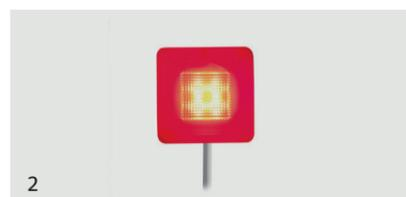
Segnalatori per interni ed esterni con Power LED per segnalazioni in impianti di sicurezza a 12 e 24Vcc. Sigillati da resine con protezione al grado IP67. Disponibili in 5 colori: Rosso, Verde, Giallo, Bianco e Blu. Grande visibilità in tutte le condizioni di luce. Contenitore in policarbonato e facile connessione con 2 fili per luce fissa o 3 per lampeggio.
