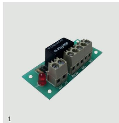
Scheda di interfaccia relè 12Vcc 3A 250Vac per consentire il corretto accoppiamento di circuiti di uscita a basse correnti che debbano pilotare carichi di potenza anche in corrente alternata a 220Vac. L'unità è composta da 1 relè in scambio. L'accensione del LED indica l'eccitazione del relè.
