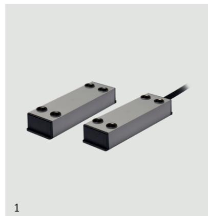
Sensore magnetico di altissima sicurezza per interni in alluminio anodizzato. Versione a triplo bilanciamento magnetico (KCH501), a doppio bilanciamento combinato (KCH502D), a doppio bilanciamento (KCH502) e di alta portata (KCH503). Connessione con cavo 4 conduttori protetto da guaina in acciaio. Fornito con tappi anti-rimozione per le viti di fissaggio.
