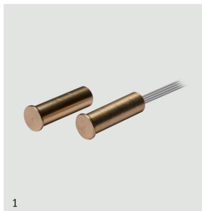
Sensore da incasso in ottone particolarmente robusto e adatto alla protezione di serramenti in legno, PVC e non ferromagnetici in generale. Il contatto è provvisto di 4 fili di uscita, 2 per il contatto NC con magnete vicino e 2 per il circuito tamper 24h. Portata maggiorata da 20 mm per porte e portoni con ampi spazi tra anta e stipite.
