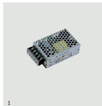
Gamma di alimentatori in box metallico a griglia con funzione di alimentazione 12Vcc o caricabatteria UPS a 13.8Vcc o 54Vcc. Connessione a morsetto, potenze da 15W a 150W.
