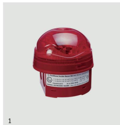
Lampeggiante a sicurezza intrinseca destinato all'installazione in aree a rischio esplosione, certificati II IG EEx/Ex IIC T4 e II IG EEx/Ex IIC T5 adatto per Zona 0, Zona 1 e Zona 2. Grado di protezione IP66. IS FLASH DOME devono essere installati con barriere di isolamento galvanico.
