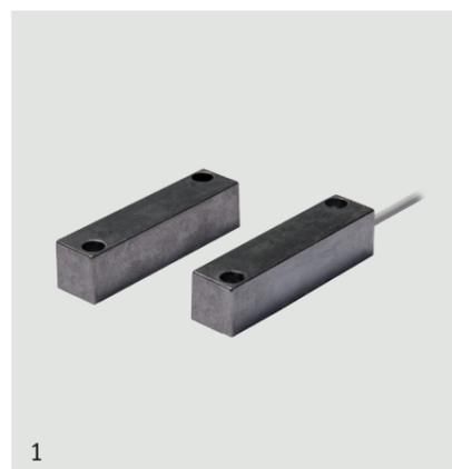
Sensore magnetico per installazione a vista su serramenti in ferro. Cavo di collegamento da 150cm a 4 conduttori. Nella confezione sono contenute le viti per il fissaggio del contatto e tappi copri vite a pressione. La distanza di funzionamento di 25 mm in aria libera garantisce un funzionamento ottimale su tutte le superfici.
