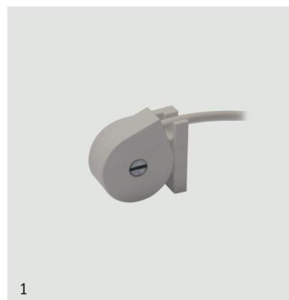
Serie di sensori inerziali elettromeccanici passivi per protezione di porte e vetrate. Contenitore in ABS adatto al fissaggio su alluminio, plastica, legno o infissi in materiale ferromagnetico. Versione da incasso, da superficie o da superficie con contatto magnetico. Necessita di scheda di analisi per contatti veloci tipo CSAI001, CSAI002 o CSAI011LP.
