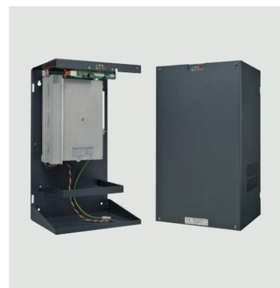
Stazione di alimentazione certificata per sistemi antincendio e di evacuazione fumi. Tecnologia lineare ad alta affidabilità con supervisione a microcontrollore per garantire il controllo dello stato di carica e di efficienza delle batterie. Uscite di allarme relè in scambio a sicurezza attiva. Uscita per i carichi sezionata con fusibili indipendenti.
