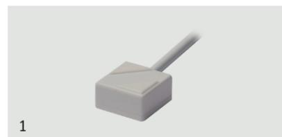
Sensore piezoelettrico rottura vetro di ridotte dimensioni. Particolarmente indicato nei sistemi via radio perché non necessita né di alimentazione né di analisi, quando è in allarme apre il circuito per un tempo che va da 2 a 30 sec. in base alla sollecitazione ricevuta. Involucro in ABS bianco o marrone.
