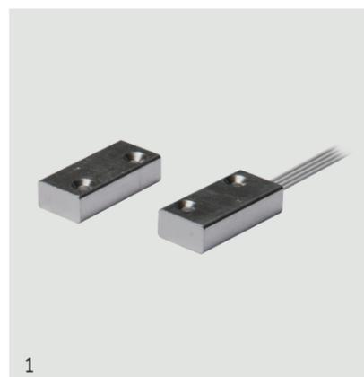
Sensore magnetico per installazione a vista su serramenti in alluminio, legno e non ferromagnetici in genere. Collegamento da 30cm a 4 conduttori. La distanza di funzionamento di 18 mm garantisce un'installazione ideale su qualsiasi profilo. Disponibile anche nel colore marrone.
